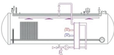
die Kühlung durch Wasservernebelung über Sprühdüsen erfolgt. In der Erhitzungsphase erhöht der um die Produkte
