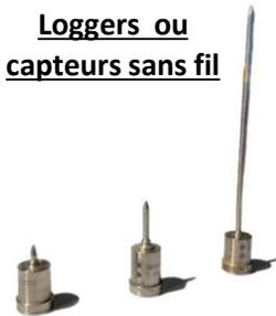
La sonde est placée au niveau du point critique du produit, c'est-à-dire au point où le traitement thermique est le plus faible. Elle permet de mesurer la température à cœur du produit et de la suivre en temps réel.
