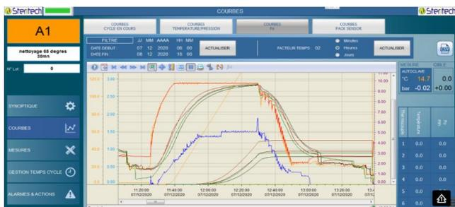
Le logiciel permet ainsi de déterminer les cycles de cuisson de manière optimale selon deux possibilités :
